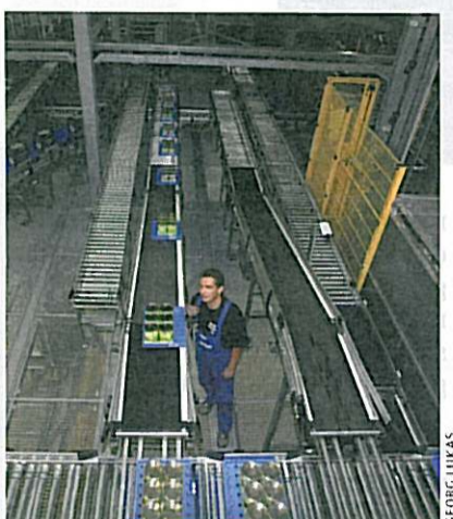
Automatisiert: Im Edeka-Logistikzentrum Hamm sorgt automatische Förder- und Kommissioniertechnik für reibungslose Prozesse.
