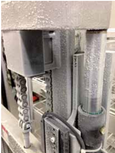
Abb. 3: Hochhubwagen nach drei kurzzeitigen Aufenthalten im -70^{\circ}\text{C} -Bereich.
